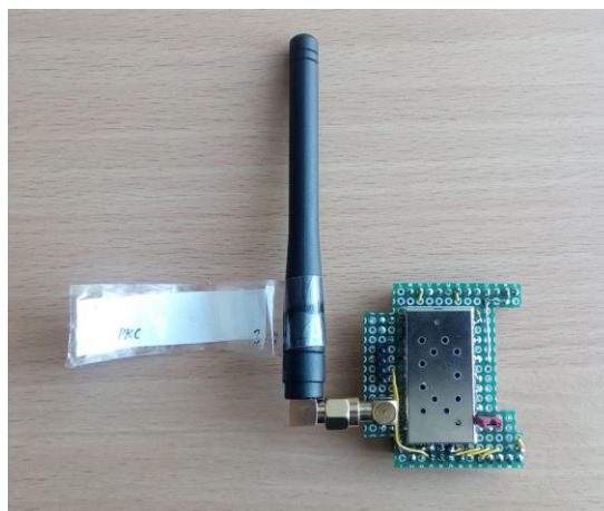
Fot. 5.7.2. Radiostacja na module cyfrowej obróbki sygnałów DRA818 (V lub U w zależności od zakresu) dla domowych węzłów Echolinku albo bramek APRS
