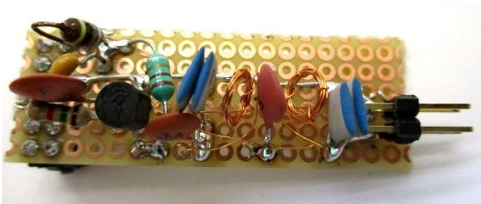
Fot. 5.2.1.2. Konstrukcja wzmacniacza mocy na płytce dziurkowanej (źródło https://www.elektronik-labor.de/HF/WSPR.html )
